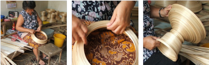
ภาพที่ 3 การขึ้นรูปผลิตภัณฑ์จากเส้นตอกด้วยวิธีการขดเส้นตอกต่อซ้อนกันจนได้รูปทรง หมูบ้านศรีป็นคร้ว ตำบลท่าศาลา อำเภอเมือง จังหวัดเชียงใหม่ (Patcharametha, 2009: 31)
